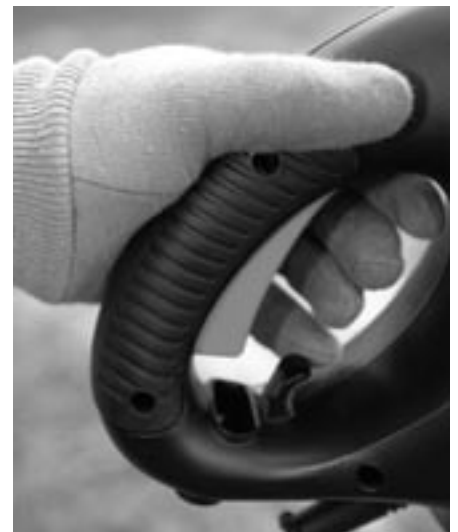
Figure 3-8 : Relâchez l'interrupteur arrière pour arrêter le taille-haie.
